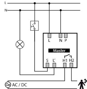
**Параллельная схема Master-Slave**
